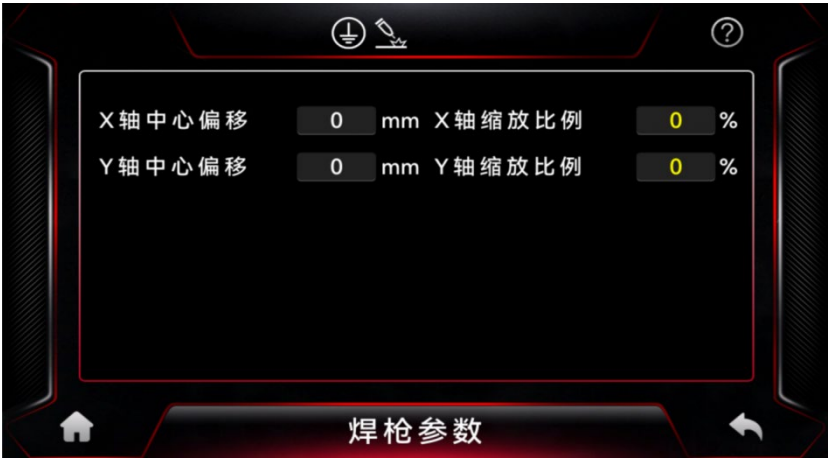
图 3-24 控制面板·设置页·焊枪参数
