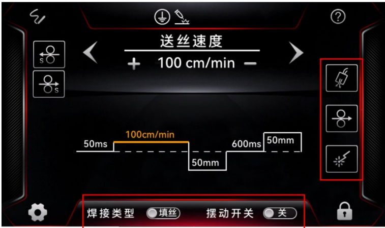
图 3-11 控制面板·首页快控键：送丝参数
