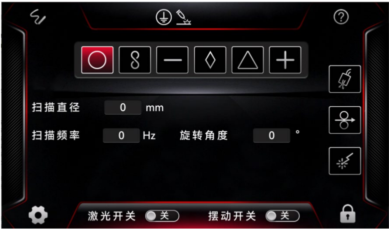
图 3-8 控制面板（专业模式·参数风格）首页：焊枪参数
