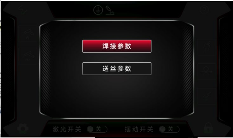
图 3-3 控制面板（专业模式·曲线风格）首页：曲线切换
