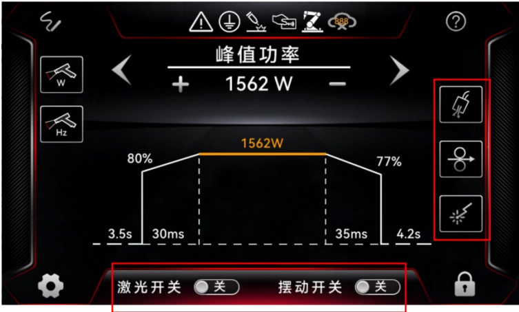
图 3-10 控制面板·首页快控键：焊接参数
