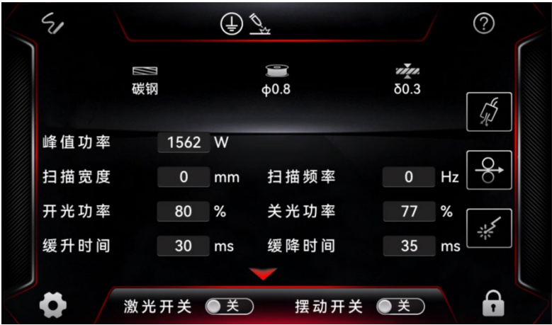
图 3-4 控制面板（专业模式·参数风格）首页：功率曲线
