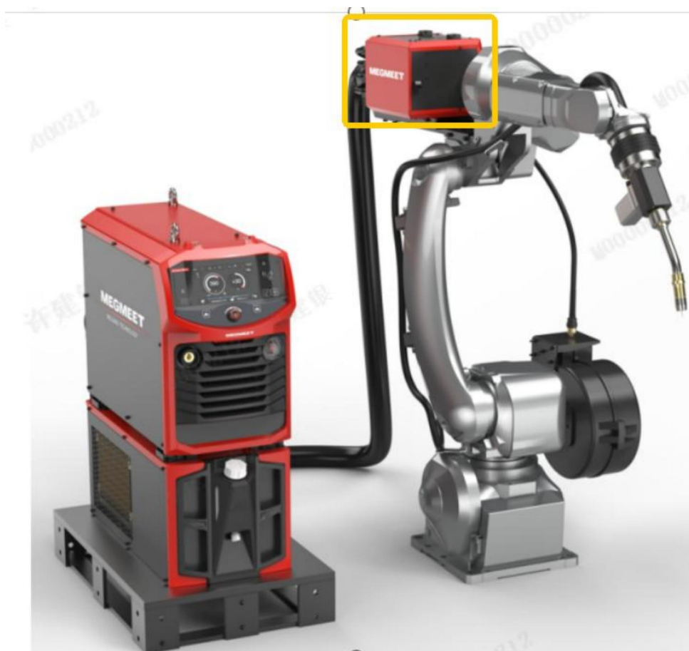
图 1-1 机器人推拉丝焊接系统送丝机示意图
