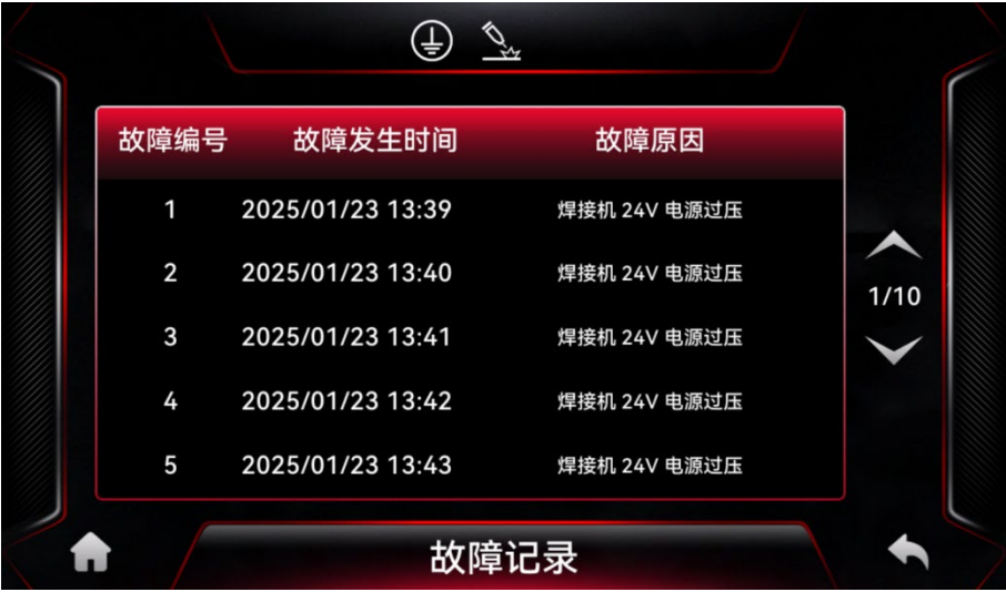
图 3-15 控制面板 · 设置页 · 系统参数 · 故障记录
