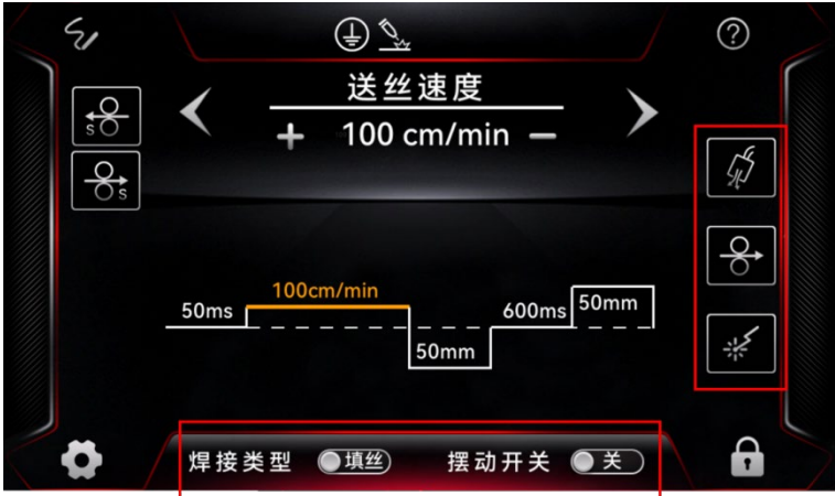
图 3-11 控制面板·首页快控键：送丝参数
