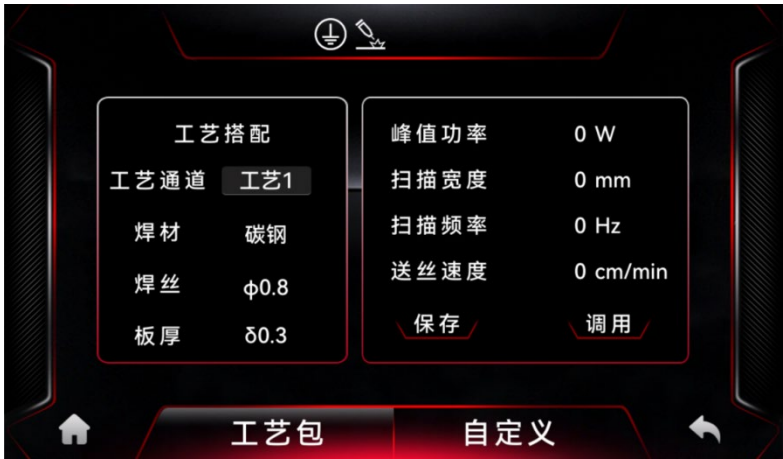
图 3-13 控制面板·工艺页·自定义工艺包
