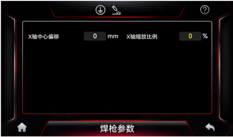
图 3-24 控制面板 · 设置页 · 焊枪参数
