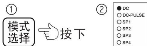
用于选择焊接工艺，分别是直流 DC、直流脉冲 DC-PULSE。
