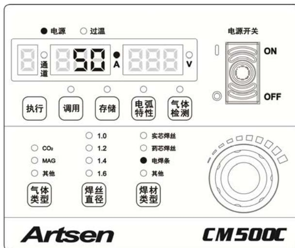
图3-37 手工电弧焊设置界面
