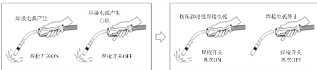
图3-9 有收弧焊接示意图
