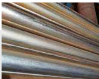
锅炉膜式壁 抗干扰高速焊
