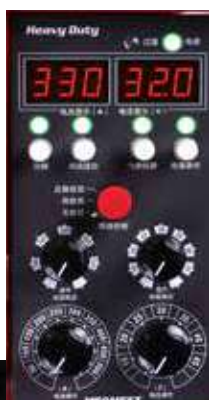
送丝机面板带 A/V 数显及常用参数设置，便于远程作业。
