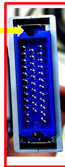
机器人端接线端子
