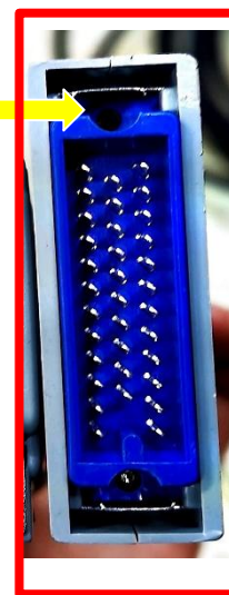
机器人端接线端子
